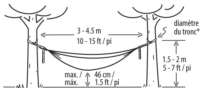
\* enroulez la sangle autour d'un arbre avec un diamètre de tronc d'au moins 30 cm pour la stabilité.
